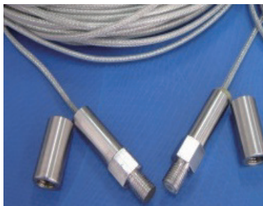
图 7 CARDC 热电偶 Fig. 7 CARDC thermocouple
