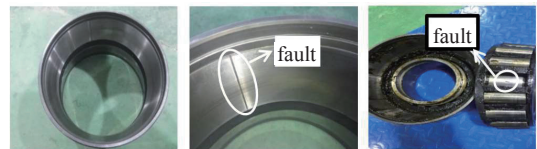
图 4 轴承外圈、外圈故障和内圈故障示意图
