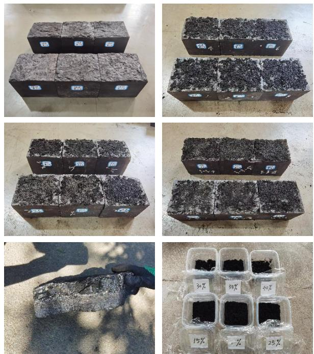
图 3 试验块体及夹层材料
