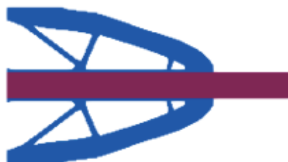
图 10 算例 1 中防弯器 2D 拓扑优化结果
