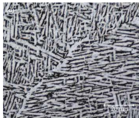
图 2 增材制造 TC4 钛合金的微观组织. (a), (c) 垂直于沉积方向; (b), (d) 沿沉积方向
