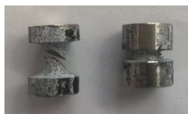
图 12 不同缺口尺寸的轴对称压缩试样加载后变化
