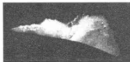
图 10 8° 攻角 NACA16012 水翼空泡云脱落
