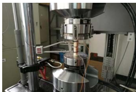
图 1 单轴压缩实验装置
