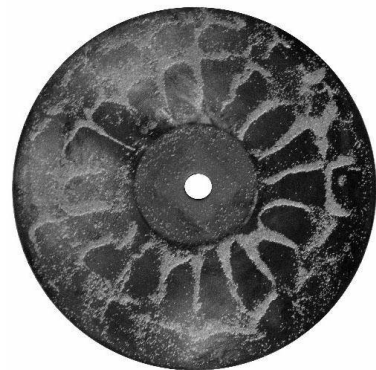
图 5 频率为 3.915 \text{ kHz} 时的实测图 ( m = 9, n = 2 )
