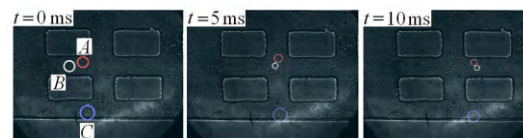
图5 红细胞在沿轴向微管道中的流动轨迹 (入口流量: 0.05 ml/h, Hct: 2%)
